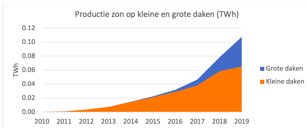
Figuur 2.11: ontwikkeling zon op grote en kleine daken. Op een groot dak passen minimaal 50 panelen (>15 kWp).
